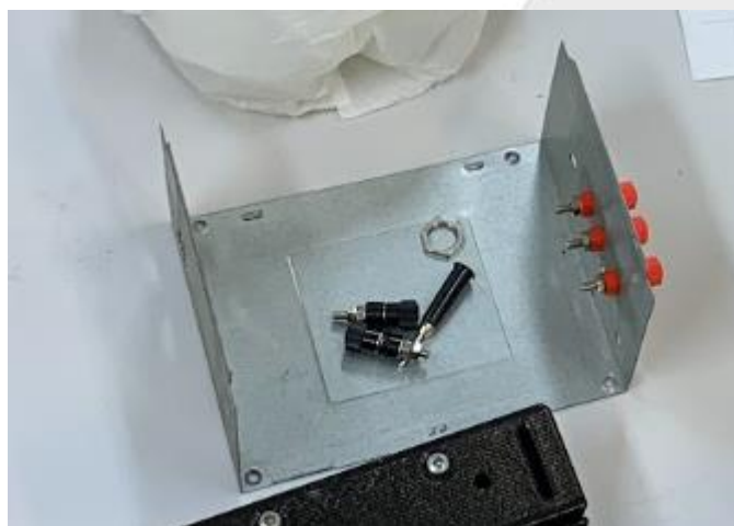
Figura 33 – Substituição Parcial dos Conectores
